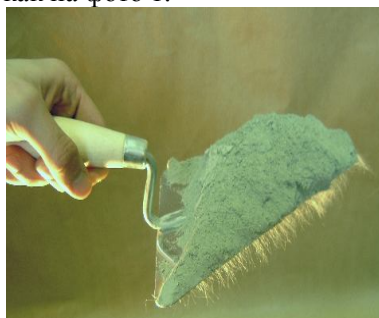
Фото 1. Сухая смесь Hygrostop-Репер с видимым полипропиленовым волокном.
